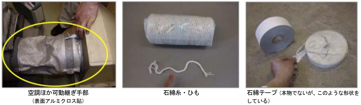
図45 石綿含有シール材の例 38)
