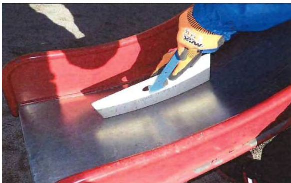
すべり台の角度の点検
