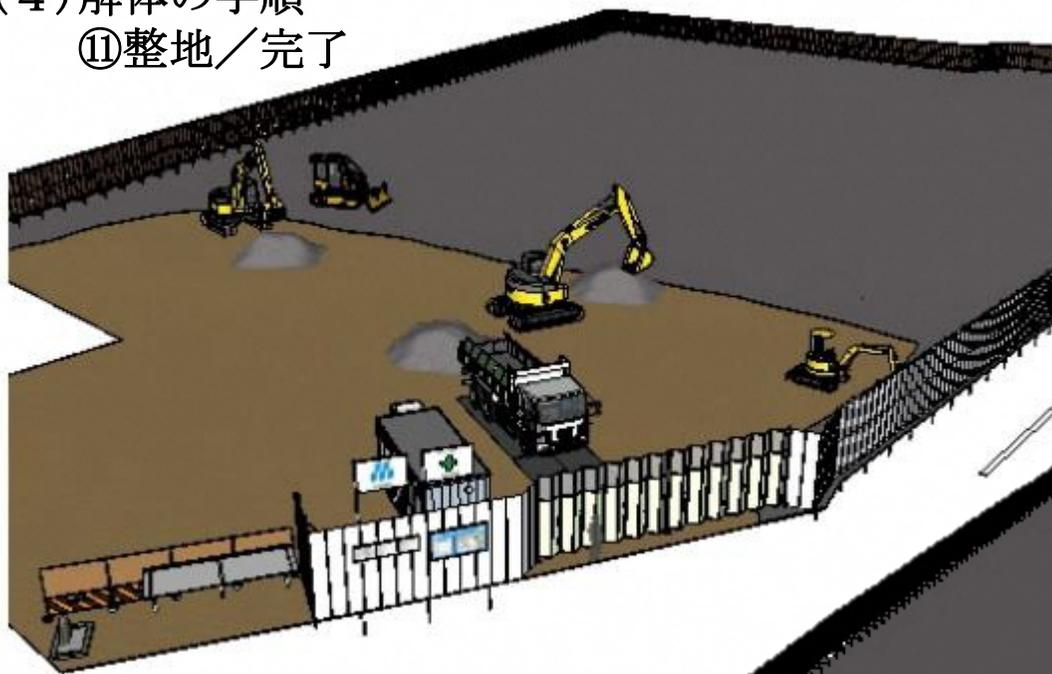
外構解体が終わり、粗整地完了後、碎石を搬入しつつ整地を行います。仮囲い周辺の細かな箇所はミニユンボにて碎石敷き込みを行い、広い場所は大型重機等にて碎石を敷いていきます。
