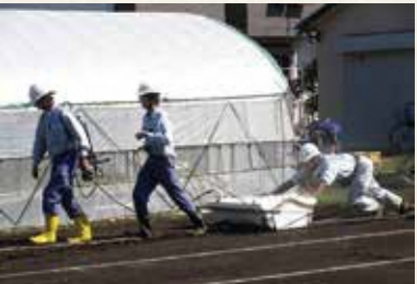
地中レーダー探査の様子
