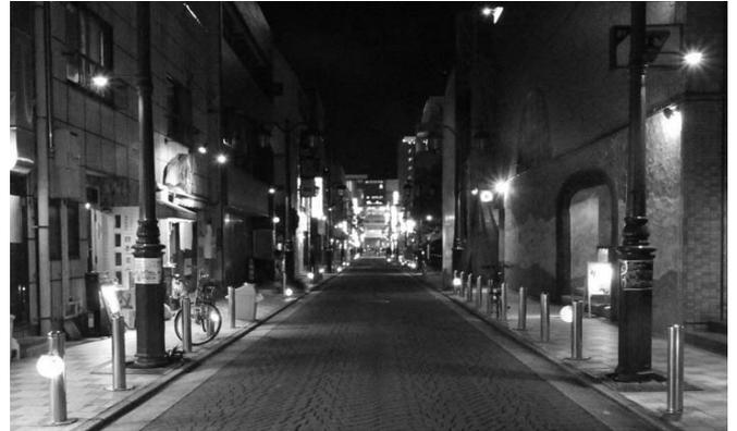
実験時は既存の高さ6mのボール灯を消灯し、高さ3.5mの位置にレフランプを下向きに取り付けた。また歩道の足元に電球を取り付けた。道路照明と沿道建物照明の、色・配置・強さなどが呼応するように調整されている。
