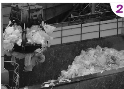
2 クレーンで持ち上げてラインへ。破袋機で袋を取り除く
