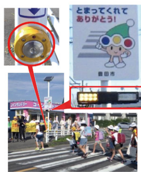
歩行者横断点減機 (愛知県豊田市ホームページより)
