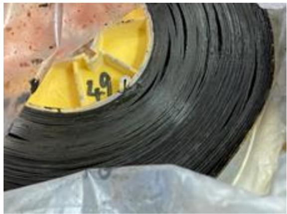
【写真2】ビネガーシンドロームによる劣化が進行し、溶解しているフィルム。ベタ付きがあり、強い酢酸臭を放つ。
