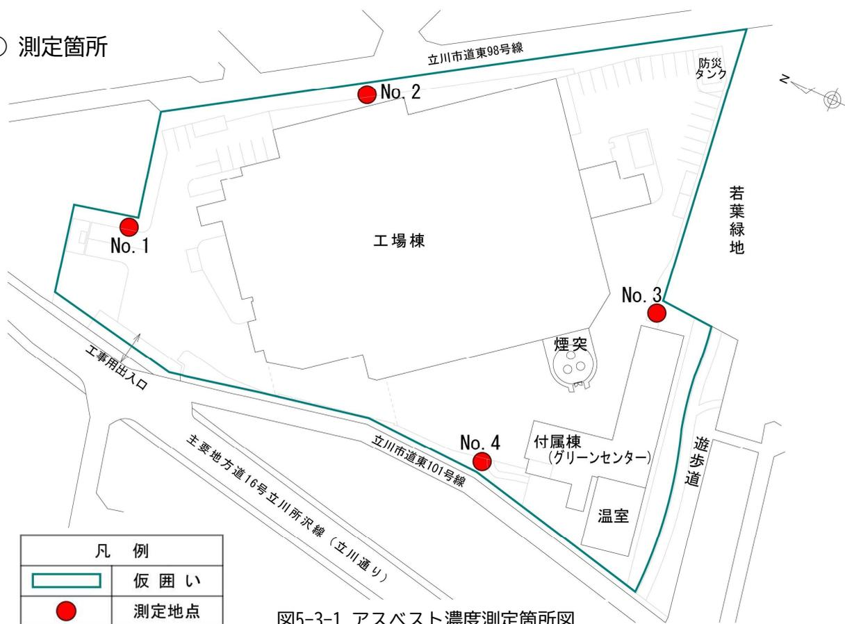
図5-3-1 アスベスト濃度測定箇所図
