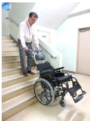
学校へ配備した階段昇降機
