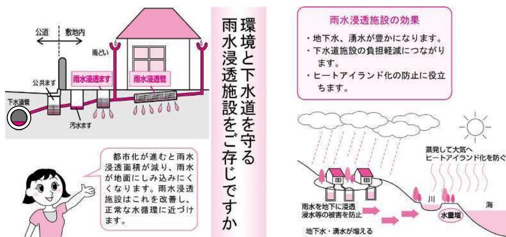
図 4-13 浸水対策（雨水浸透施設）について
