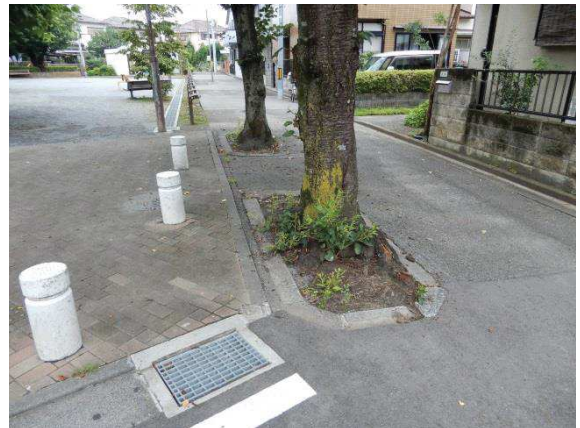
写真：狭い植栽基盤で生育しているサクラ（東132号線）
