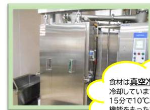
食材は真空冷却機という機械で冷かしています。15分で10℃以下に急速冷却できる機能をもった機械です。
