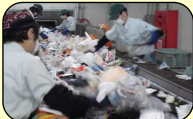
収集したプラスチックごみをリサイクルセンター内で手作業にて仕分ける
