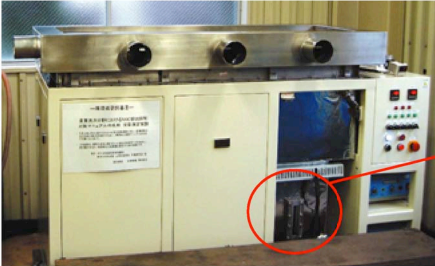
排出抑制効果を実験した定量測定洗浄装置
