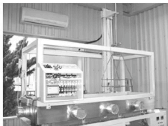
定量測定実験モデル洗浄装置付属の搬送機 (出典:産業洗浄VOCマニュアル委員会WG)
