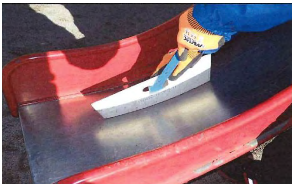
すべり台の角度の点検
