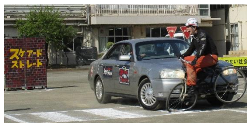
横断歩道を渡る自転車と左折する車との事故再現 (車のピラーによる死角が原因での事故)
