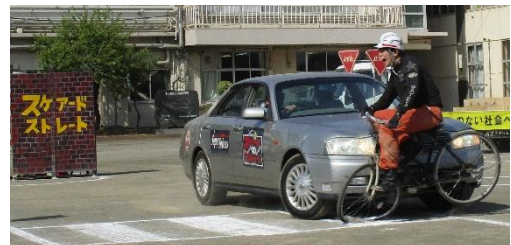
横断歩道を渡る自転車と左折する車との事故再現 (車のピラーによる死角が原因での事故)
