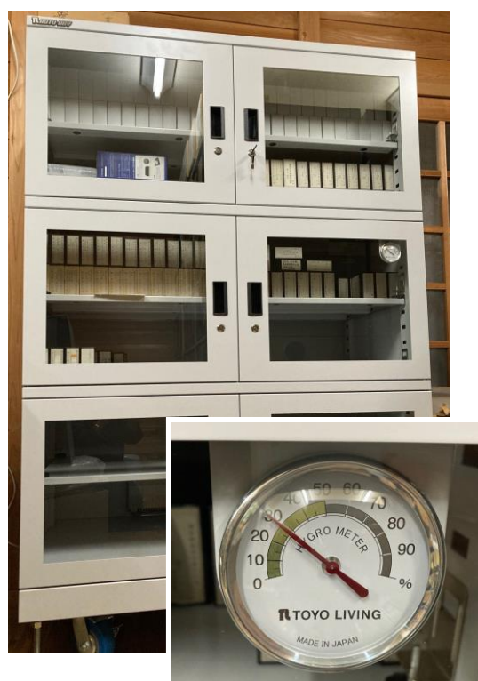
【写真4】低湿度管理ができるフィルム用ドライキャビネット。フィルム保管に適した湿度約20～40%の環境が維持されている。
