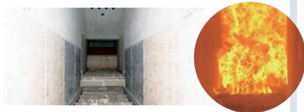
様々なごみ質に対応してそれぞれのごみ送り速度と燃焼用空気の吹込み量を調節することで、900℃以上の高温で焼却を行い、ダイオキシン類を分解します。
